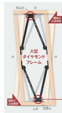
ダイヤモンドフレーム作動の仕組み
